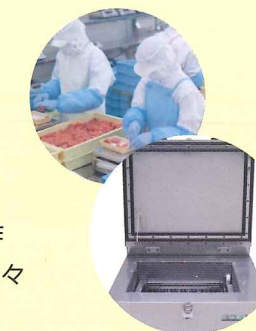
アルコール 35%焼酎甲種を凍らせた状態で食品を急速冷凍している様子。
