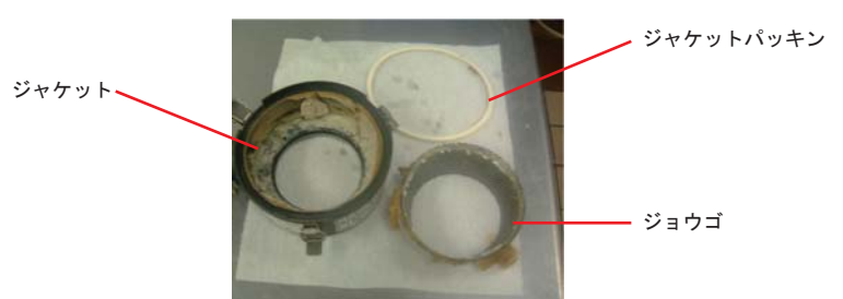
②ジャケット内の汚れ
